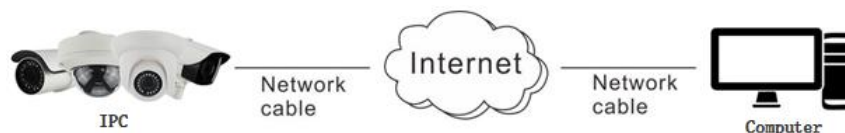
Obrázok 2-6 - Priame pripojenie so statickou IP
